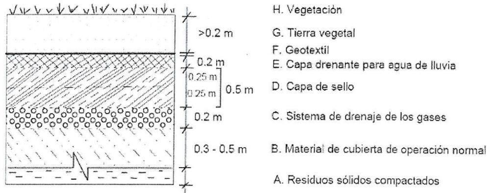
Figura 36. Diseño de cobertura final.
